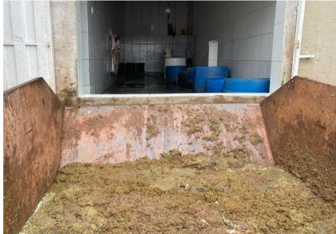
**Figura 3** – Recipiente de armazenamento de conteúdo gástrico animal utilizado no processo de compostagem, nos tratamentos B e C
