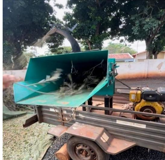
**Figura 2** – Podas urbanas utilizadas no processo de compostagem (a) e triturador dos resíduos de podas urbanas (b)
