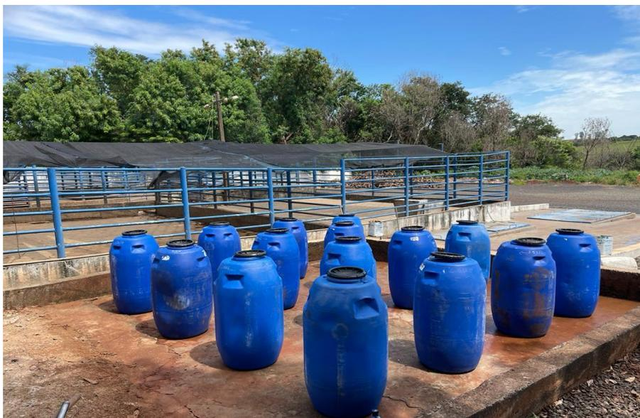
**Figura 1** – Recipientes onde foram feitos os ensaios de compostagem dos resíduos provenientes de podas urbanas e abatedouro
